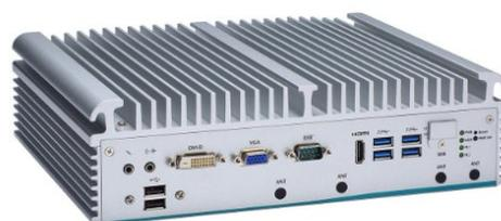
同時新推出的工業等級低功耗邊緣運算系統 eBOX100-312-FL、零售市場廣告播放系統 DSP521 的無風扇系統，即是依此理念架構所開發產生，提供 IP40 等級的無風扇系統，不僅可以避免風扇運作所造成的噪音、落塵與相關穩定性問題，亦能於寬溫環境下工作。機身輕薄短小；彈性 I/O 擴充透過監控軟體並透過網路(LAN/WLAN/WWAN)來連結到雲端資料庫，此建構將可大大減少人力成本支出與增加處理時效性，符合可靠、安全和經濟原則。eBOX100-312-FL 提供穩健的 IP40 等級嵌入式無風扇系統產品來符合工廠自動化的需求。
